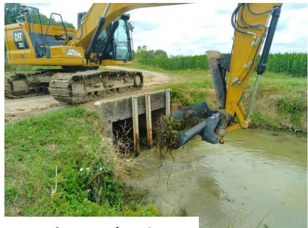
Essai d'un nouveau peigne pour arrachage mécanique
